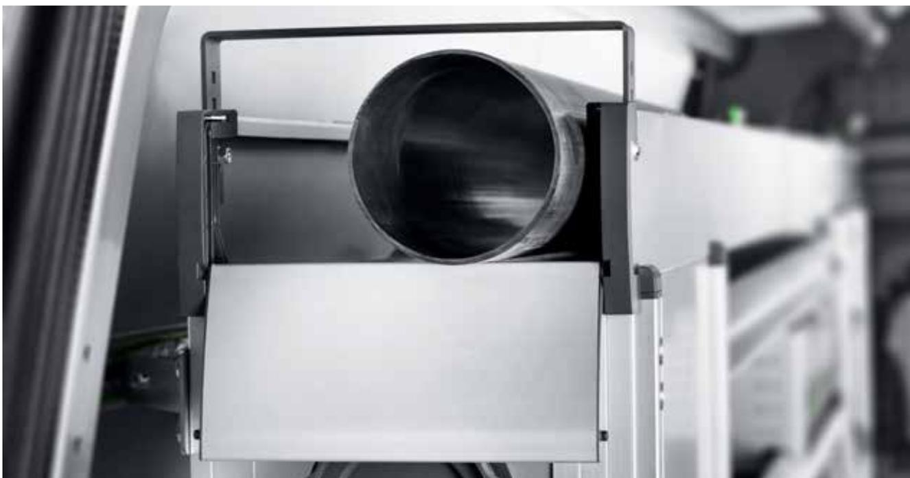
**Plataforma para cargas pesadas extraíble con guías telescópicas**
