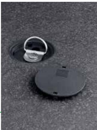
Con el equipamiento para vehículos bott vario3, los puntos de anclaje provistos por el fabricante de su vehículo industrial en el espacio de carga de la furgoneta siguen siendo accesibles.
